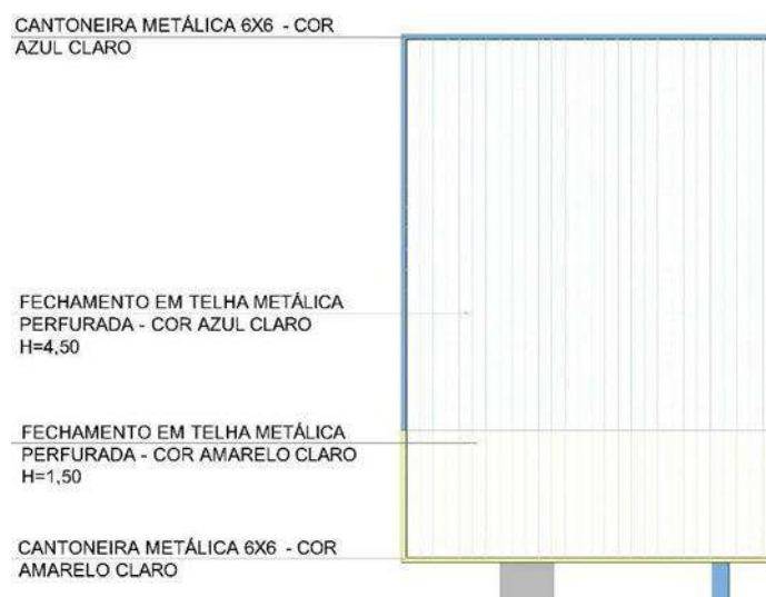
Figura 5: Imagem ilustrativa do acabamento do fechamento lateral.
